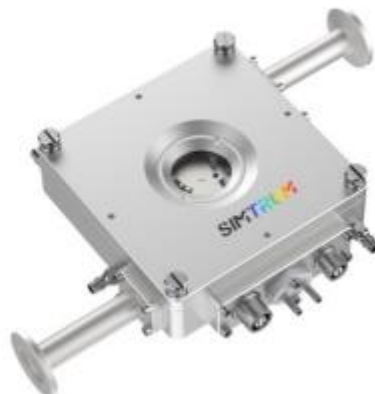
Вакуумный оптический столик с контролем температуры Механическая откачка - до 10^{-3} мбар Молекулярная откачка - до 10^{-5} мбар
