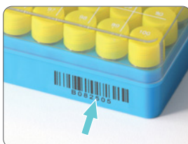
Штрихкод на стенке бокса со считывающим устройством
