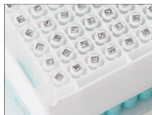
Двумерный штрихкод на дне пробирки для централизованного считывания и распознавания с помощью профессиональных сканеров.
