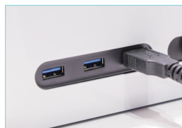
Высокоскоростной интерфейс USB 3.0 для подключения к системе библиотеки биологических образцов и автоматической их обработки.
