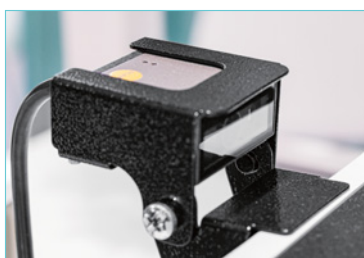
Распознаватель бокового кода с возможностью размещения с четырёх сторон для сканирования блоков SBS.
